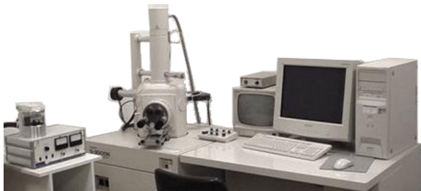
Figura 7. Microscopio Electrónico de Barrido modelo S-2400 (Hitachi).
