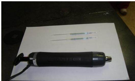
**Figura 12:** Tubo detector de gas marca Gastec.
