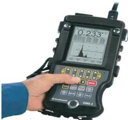
**Figura N° 12** Equipo de medición de espesores ultrasónico KrautKramer DMS 2 / 2E.
