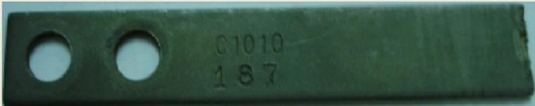
**Figura N° 34** Cálculo de velocidad de corrosión.
