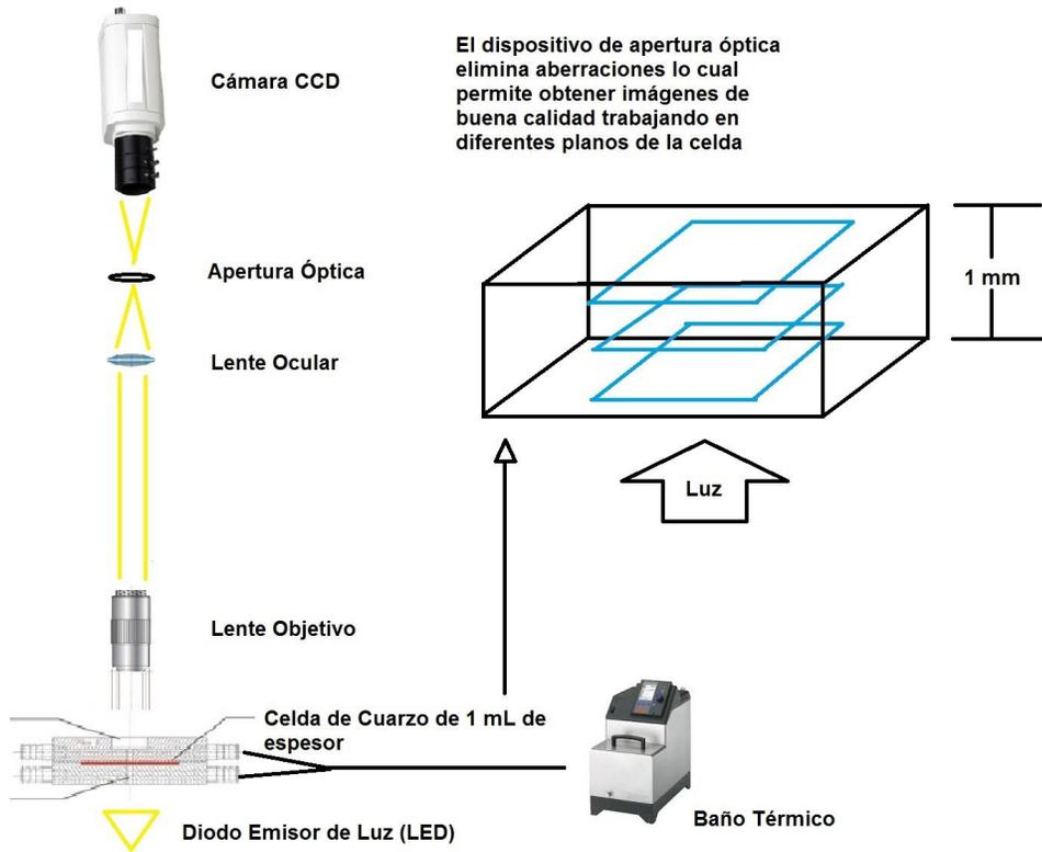
**Figura 3.1:** Esquema experimental del sistema óptico ensamblado.
