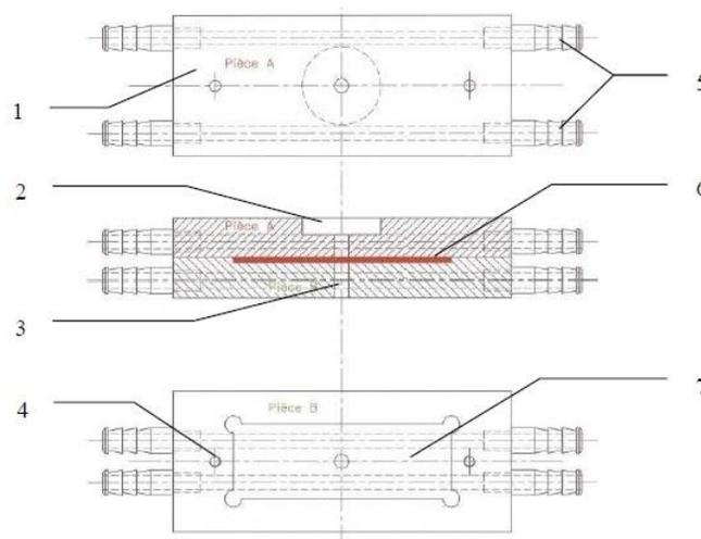
**Figura 3.2:** Esquema de la celda de regulación térmica.
