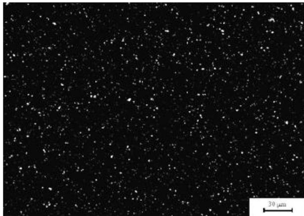
**Figura 1.9:** Efecto de la velocidad de enfriamiento en la morfología de los cristales a  $0,75^{\circ}\text{C}/\text{min}$ .<sup>[30]</sup> "Tomado con permiso de la Elsevier".
