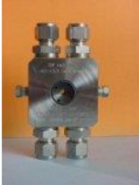
**Figura 3.22:** Foto de celda empleada en el laboratorio de Fluidos Complejos de la Universidad de Pau para el trabajo a alta presión.
