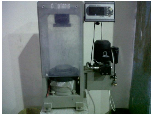
Figura N° 2. Equipo de Compresión de Cilindros de Concreto
