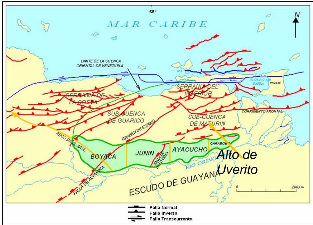
Figura 5. Rasgos estructurales de la Faja Petrolífera del Orinoco. Nótese como el sistema de fallas de Hato Viejo divide a la zona en dos provincias. (Tomado de Salazar, 2014).
