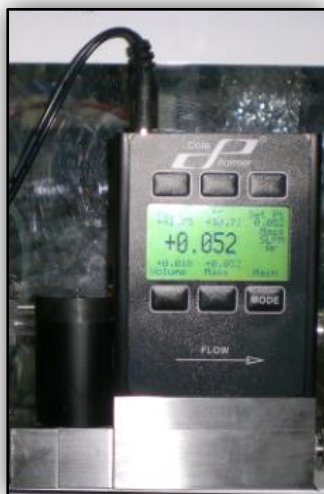
Figura N°15. Controladores de Flujo.
