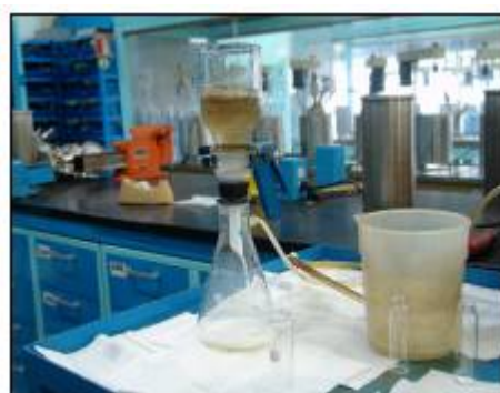
Figura III.3. Sistema de filtrado de la muestra. (Carrasquero, 2008)
