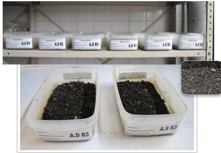
Figura No 21. Bandejas o composteros utilizados en el proceso de biorremediación. (Fuente: Propia, s.f)
