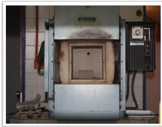
Figura No 18. Mufla empleada para la modificación térmica del material vegetal. (Fuente: Propia, s.f).
