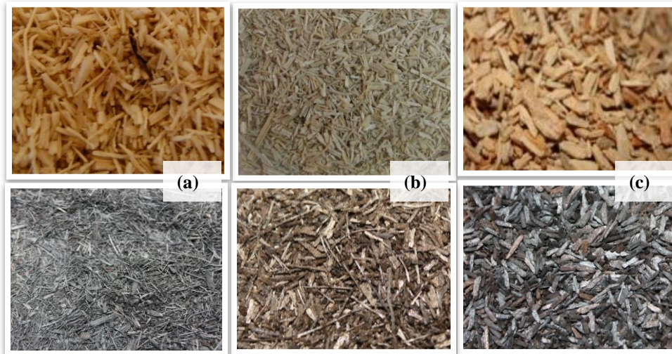
Figura No. 27. Materiales celulósicos antes y después del tratamiento térmico: (a) Fibra de Coco, (b) Bagazo de caña de azúcar y (c) Aserrín de pino. (Fuente: Propia, s.f)
