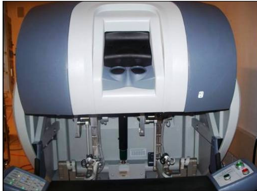
Visor tridimensional de la consola del Da Vinci, que permite al cirujano manipular los instrumentos previamente insertados en el cuerpo del paciente
