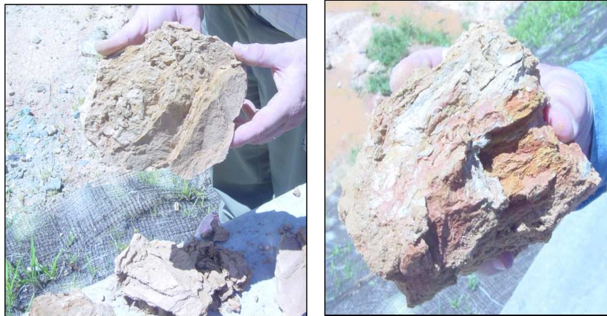
Figura 3.4. Evidencia geológica de sedimento lacustre en la Zona Rental de la UCV. En las figuras se observan el aspecto varvado limo-arcillosas de color marrón amarillento. Cortesía Ing. Roberto Centeno W.
