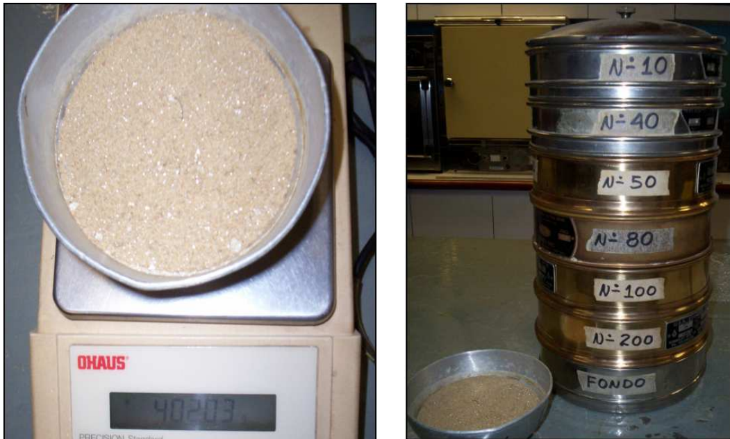
Figura 3.15. Ensayo de granulometría. Fotografía: Ramos 2010
