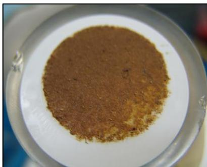
Figura 18. Papel de filtro de  $0,45\ \mu\text{m}$  con depósitos de carbonatos de calcio y materia orgánica
