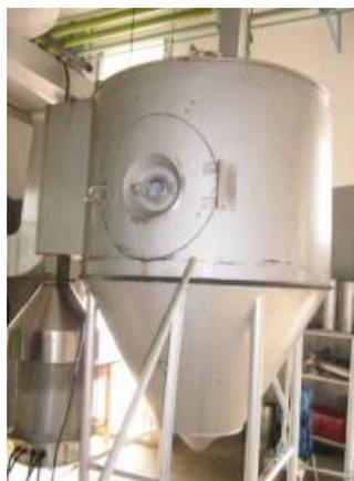
Figura 33. Cámara de secado *Spray Dry***(b) Escenario 2: con tratamiento térmico**
