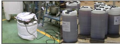
Figura 62. Montaje experimental del equipo de preparación y almacenamiento del inhibidor de incrustaciones
