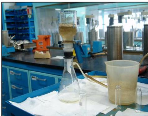
Figura 17. Sistema de filtrado de la muestra
