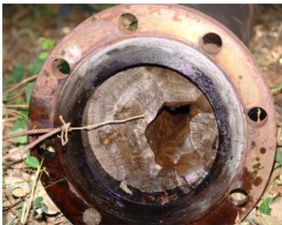
Figura 2. Tubería con incrustaciones de  $\text{CaCO}_3$  perteneciente a un pozo del Estado Barinas
