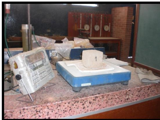
**Foto 37: Peso de la probeta seca**
