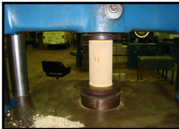
**Foto 32: Ensayo de compresión**
