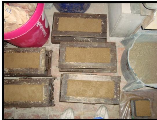
**Foto 20: Probetas de suelo-cemento**
