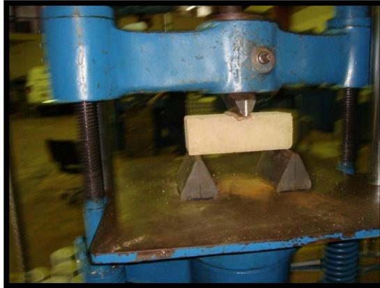
**Foto 35: Probeta a ensayar a flexión**
