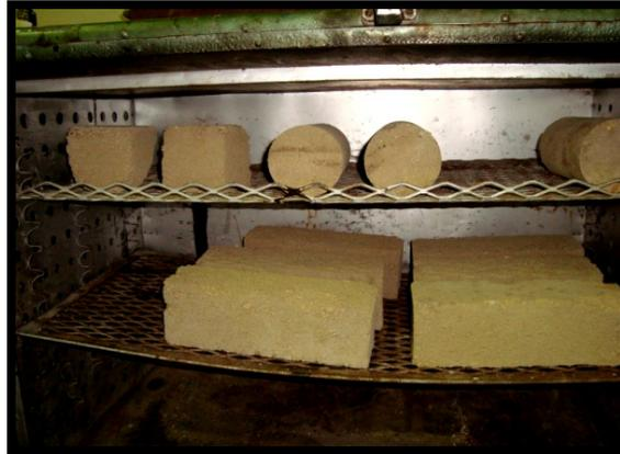
**Foto 26: Probetas en el horno**
