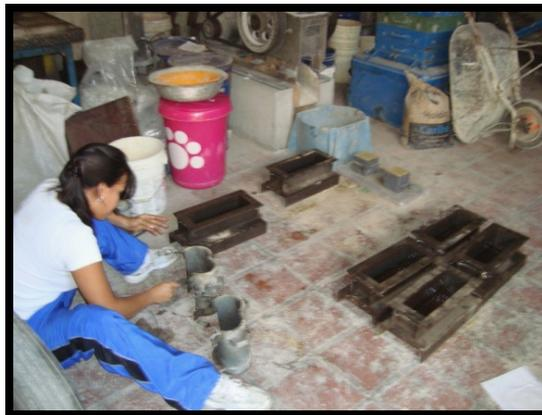
**Foto 19: Colocación de aceite en el molde**
