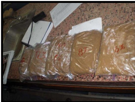
**Foto 12: Muestras para ensayo de compactación**
