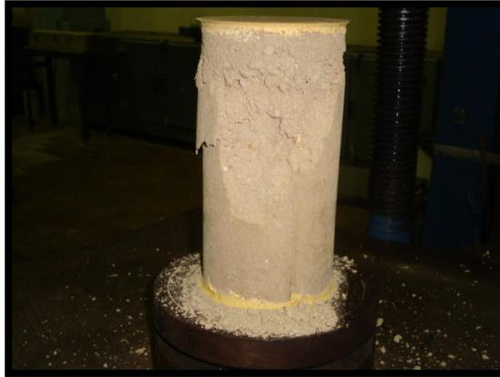
**Foto 33: Falla de la probeta de suelo-cemento 10%**
