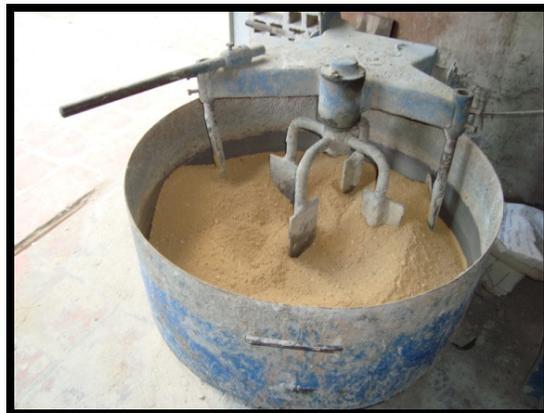
**Foto 14: Mezclado de suelo-cemento**
