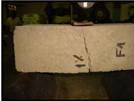
**Foto 36: Falla de la probeta**
