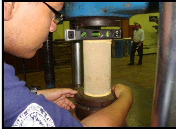
**Foto 31: Preparación del cilindro en la máquina de compresión**
