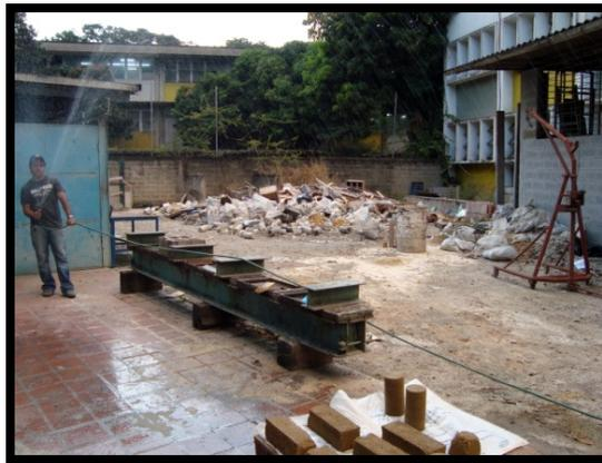
**Foto 24: Curado de las probetas**
