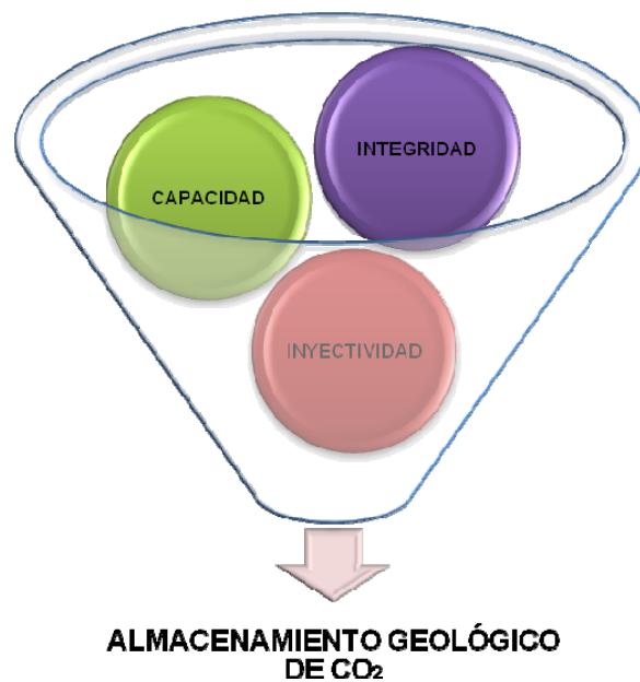
Figura 3.5 Parámetros a considerar para el almacenamiento geológico de CO 2 Realizado por: Caballero (2010)
