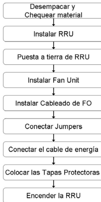
Figura 20. Flujo de trabajo para la instalación de RRU [15]
