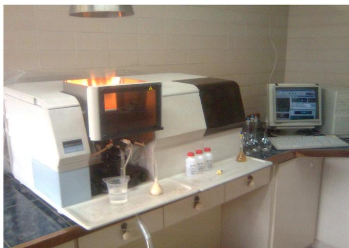
Figura 3.11. Espectrofotómetro de absorción atómica utilizado para la ejecución del ensayo.
