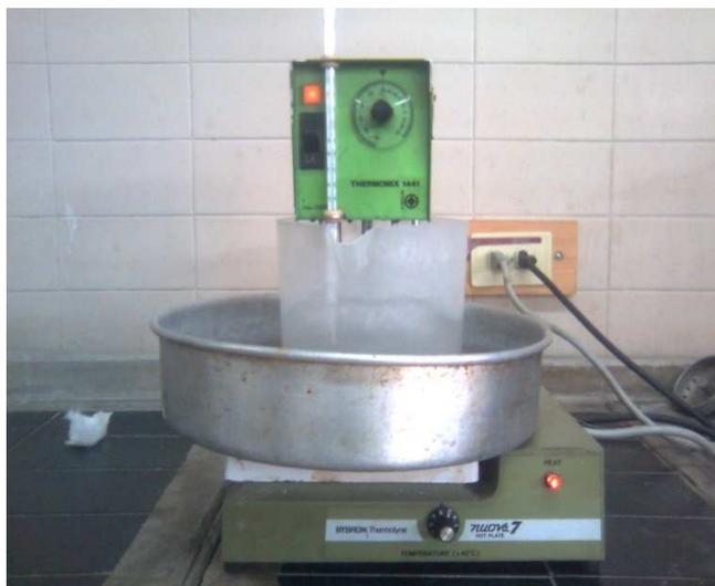
Figura 3.8. Montaje Experimental utilizado durante los ensayos de inmersión dinámica
