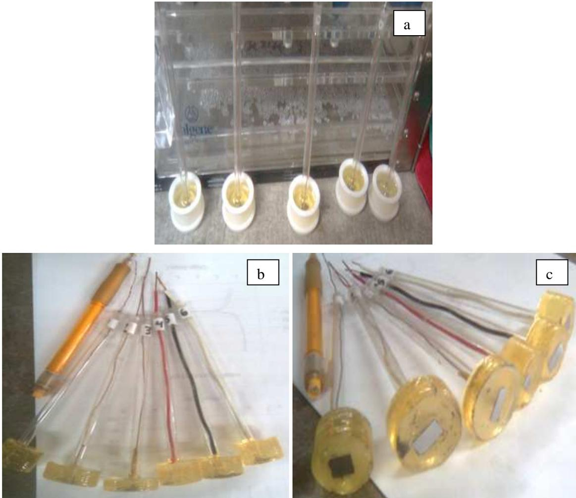
Figura 3.9. Electrodo de Trabajo: a) Montaje de muestras una vez preparada la mezcla. b) y c) Muestras Embutidas en frío.
