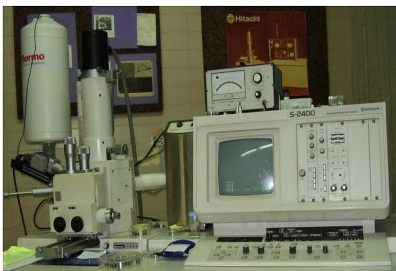
Figura 3.12. Microscopio Electrónico de Barrido (M.E.B.) marca Hitachi, modelo S-2400.
