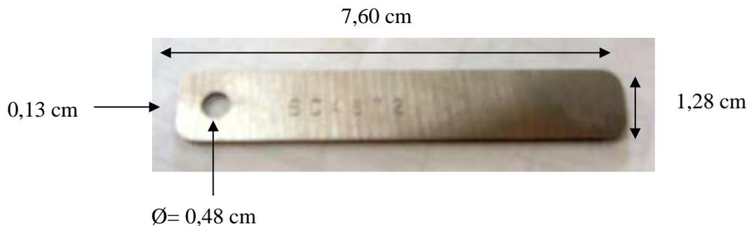
Figura 3.4. Dimensiones del cupón Nalco usado en pruebas de laboratorio.
