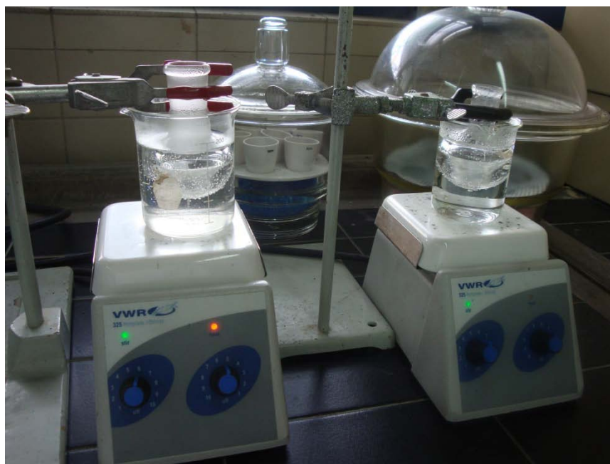
Figura 49. Montaje de reacción. Método del citrato
