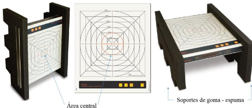
Fig. 3.16 Cámara PDC, para verificación y calibración del DAP (Manual Radcal, 2009).
