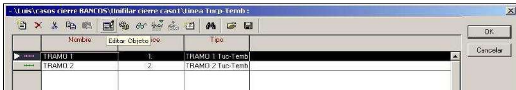
(Figura A.12.4.3.5) Ventana para visualización , creación y edición de tramos y/o secciones de la línea de transmisión
