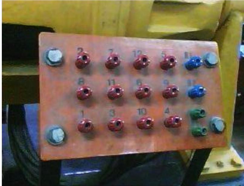
**Figura 31. Configuración de los bornes de la armadura de MQ2**
