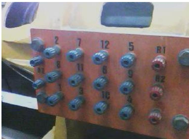
**Figura 30. Configuración de los bornes de armadura de MQ1**
