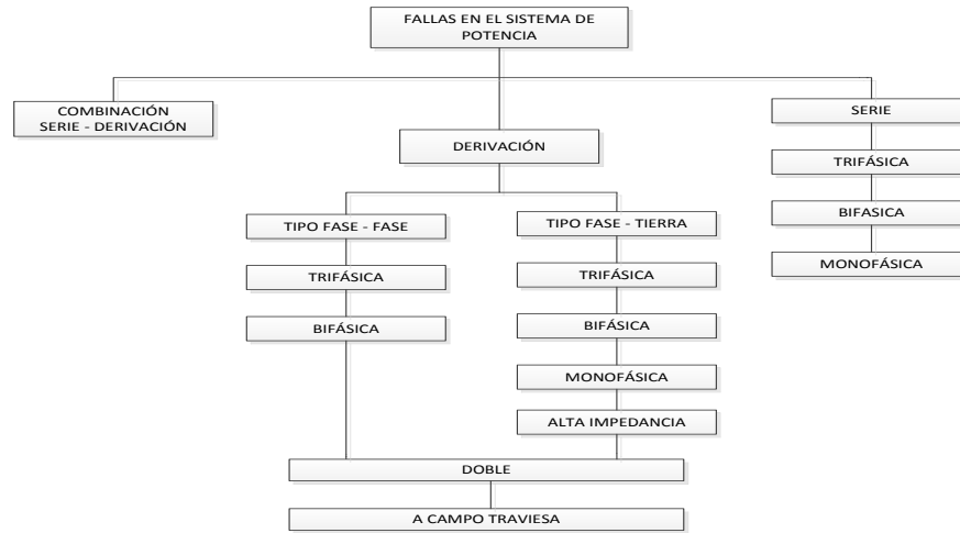
Figura 2: Fallas propias de los Sistemas de Potencia
