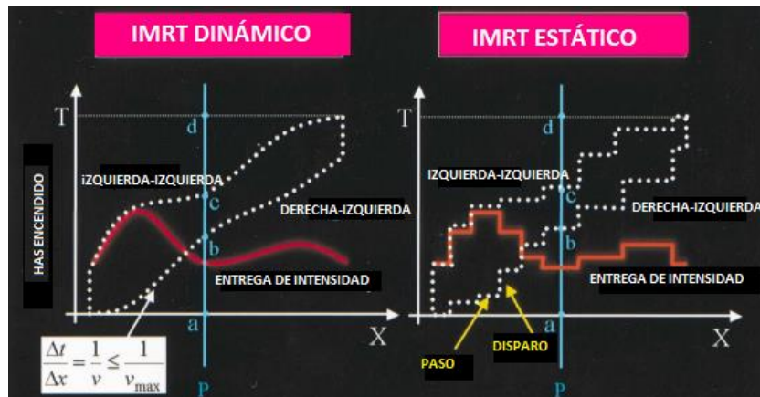
Figura 3.13.: Perfiles de intensidad entregada por las multilaminas, con la técnica dinámica y estática [25].
