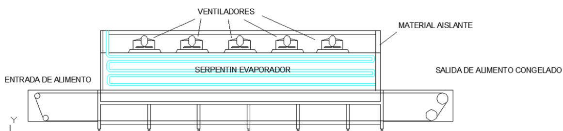
Figura 12. Túnel lineal continuo, enfriamiento con Refrigerante.
