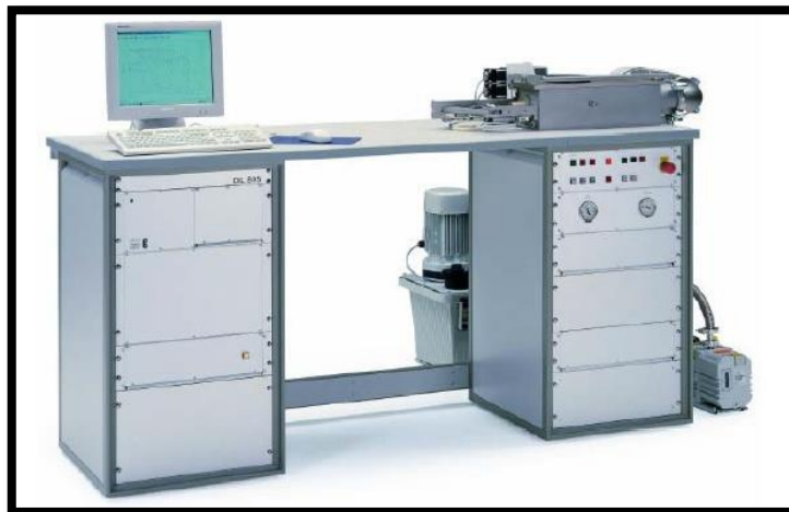
Figura 3.29 Dilatómetro 805 Bähr, utilizado para los ensayos de compresión en caliente
