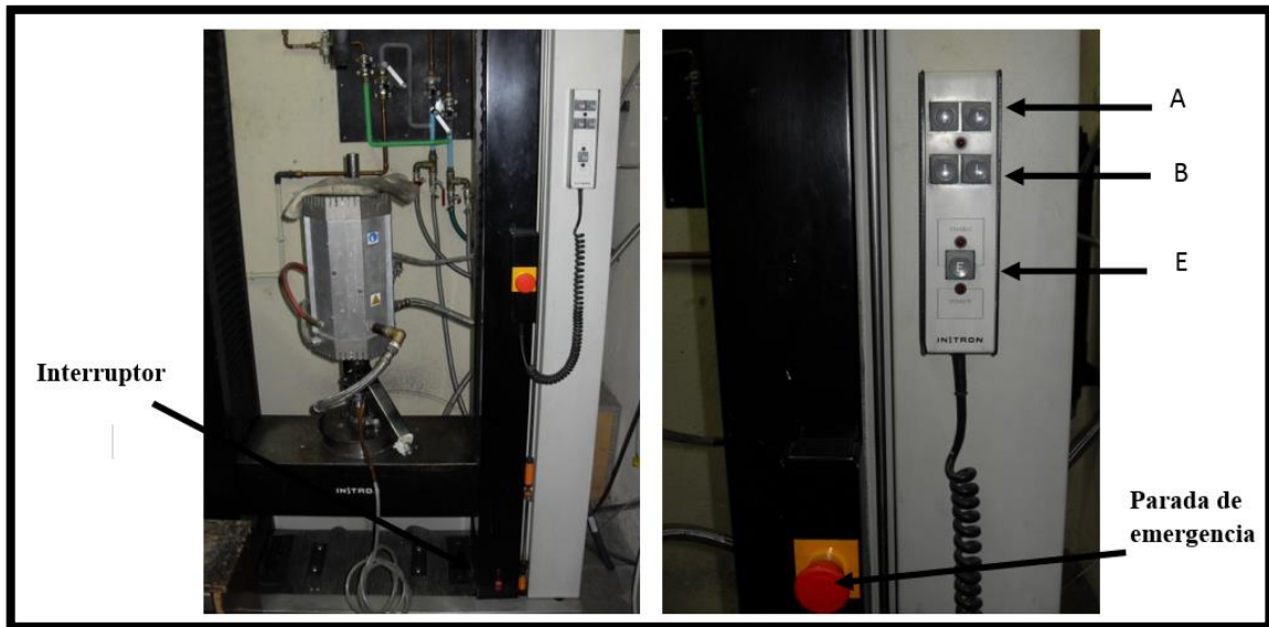
Figura 3.20 Interruptores maquina Instron
