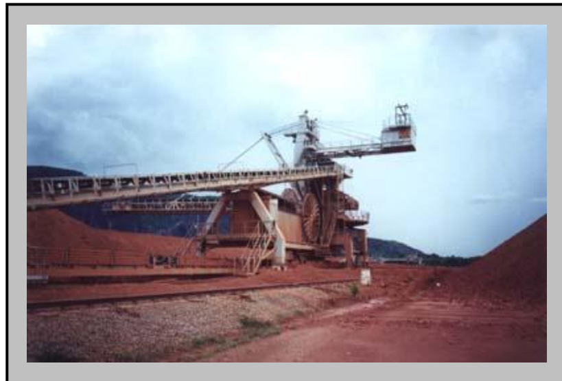
Figura 4.6. Apilador de 1600 t/h de capacidad.
