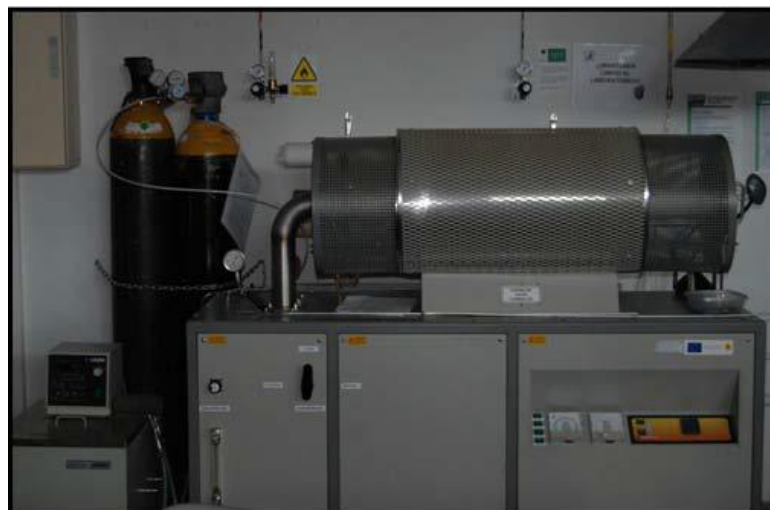
Figura 3.2. Horno Tubular de alto Vacío
