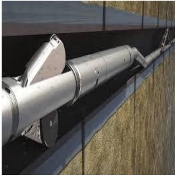
Figura nº 4. **Tractor de pozo “TuffTRAC-XTRA-A”, en trabajo operacional.** T Shereitov. Manual de mantenimiento del TuffTRAC, versión 1.9. 2013.
