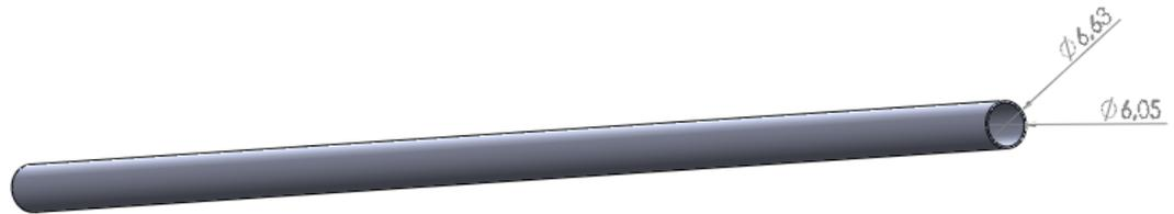
Figura n° 25. Tubo de revestimiento de 6 5/8 pulgadas de diámetro externo, 0,288 pulgadas de espesor y 15 pies de longitud. Fuente: el autor.
