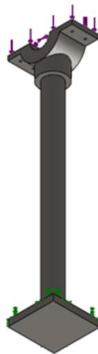
Figura nº 49. **Fijación del apoyo al piso y colocación de las fuerzas actuantes.** Fuente: el autor.
