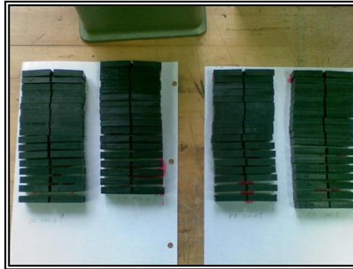
Figura 52. **Serie de probetas ensayadas en la máquina universal modelo Lloyd EZ20.** Fuente propia.
