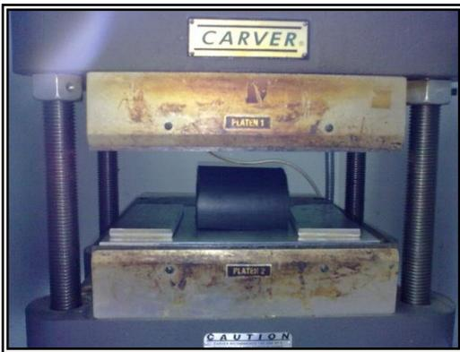
Figura 42. **Muestras longitudinales colocadas en Prensa Carver.** Fuente Propia.
