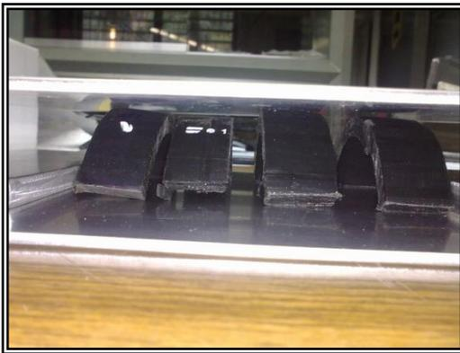
Figura 33. **Muestras circunferenciales colocadas entre planchas de acero.**
