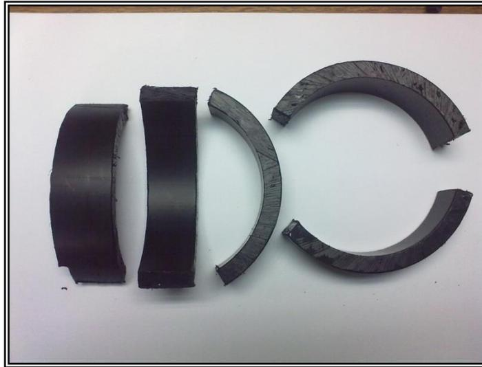
Figura 30. **Muestras circunferenciales tomadas de la tubería.** Fuente propia
