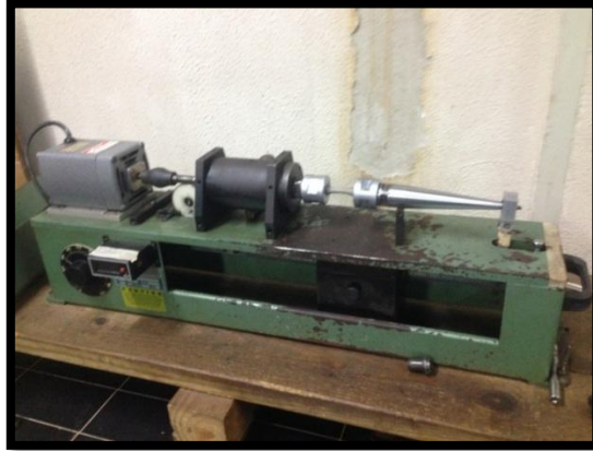
Figura 24 Máquina de fatiga por flexión rotativa marca Fatigue Dynamics, modelo RBF-200.
