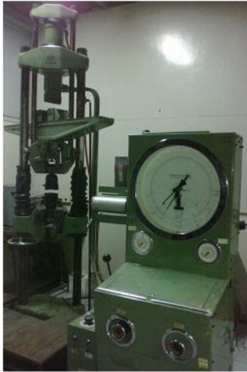
Figura 23 Máquina de ensayo de tracción Losenhausen, año 1969
