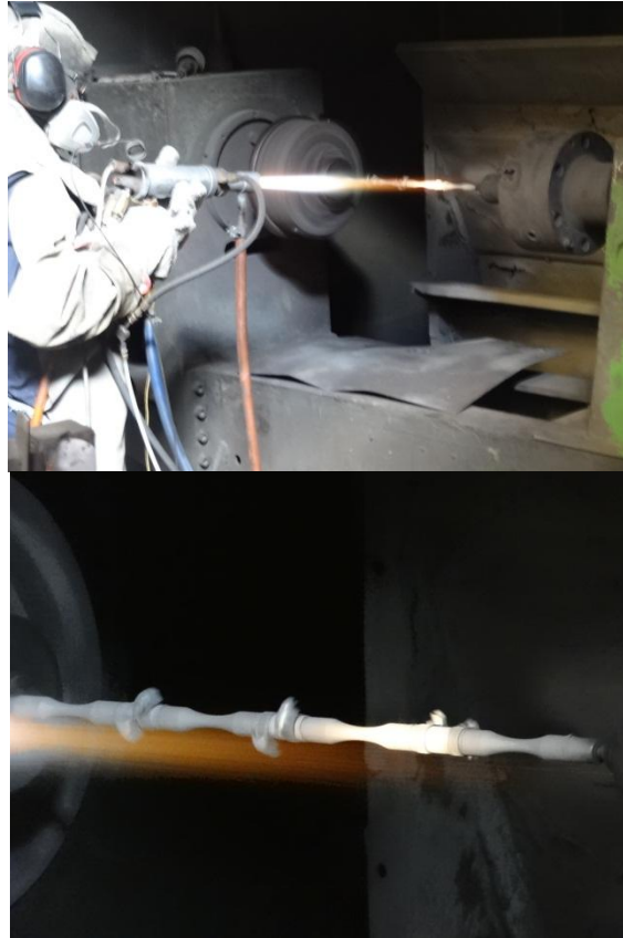
Figura 22 Proceso de rociado térmico por HVOF.
