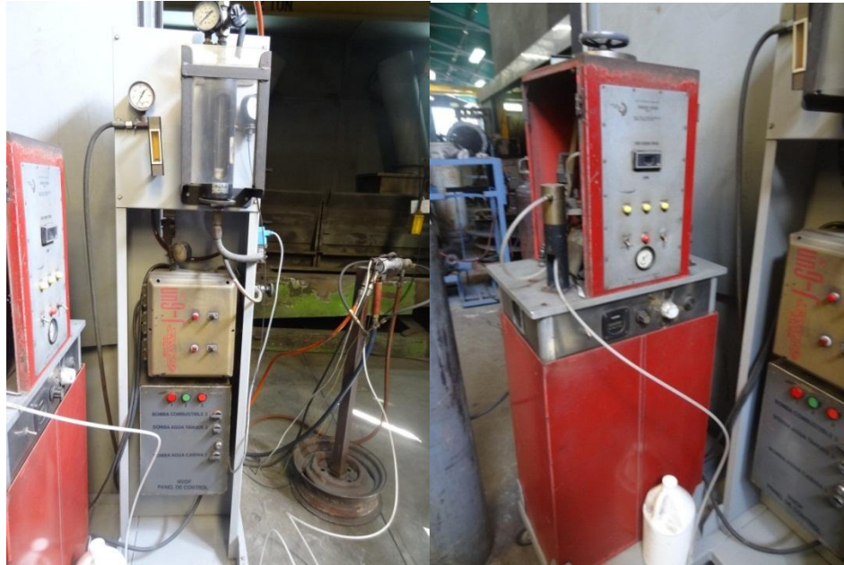
Figura 21 Equipo de termorrociado HVOF propiedad de Plasmatec Ingenieros S.A.
