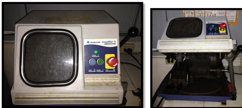
Figura 27 Cortadora de disco abrasivo marca BUEHLER SAMPLMET 2
