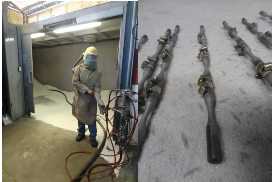
Figura 19 Sala de granallado o sandblasting y probetas luego de ser granalladas
