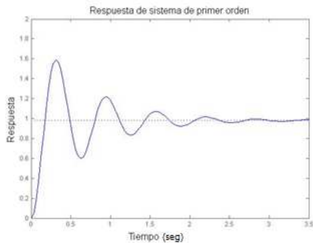
Figura 8: Respuesta a un sistema de segundo orden, subamortiguado con una entrada tipo escalón.
