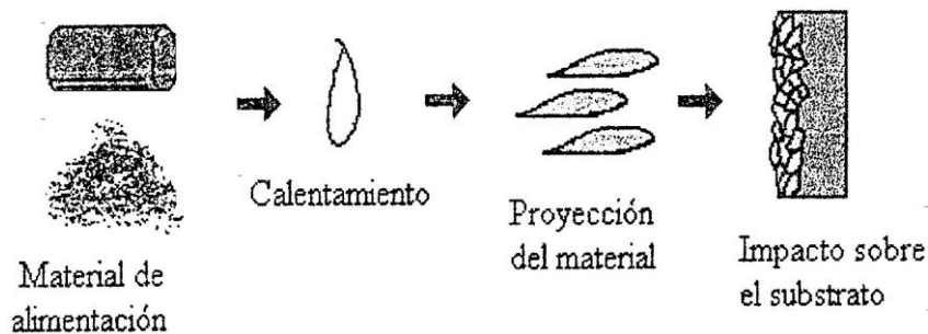
Figura 2-9. Pasos elementales en un proceso de rociado térmico
