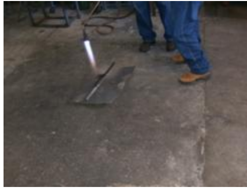
Figura 3-5. Precalentamiento de las probetas
