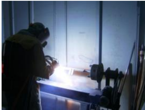
Figura 3-8. Proceso de rociado térmico por plasma
