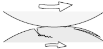
Figura 2-5. Esquema del Desgaste por Fatiga Superficial.
