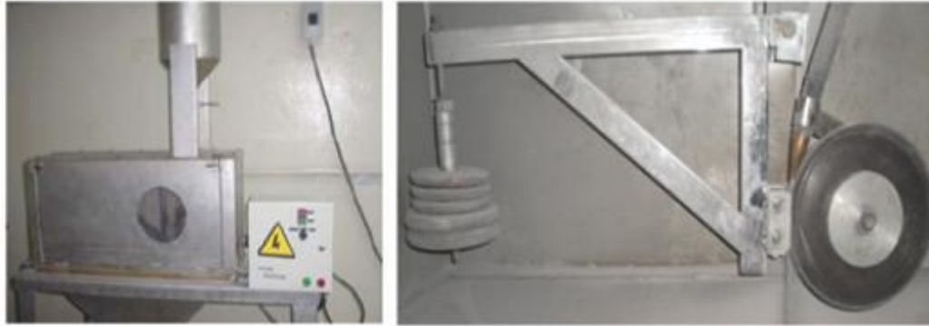
Figura 3-13. Máquina de ensayos de abrasión
