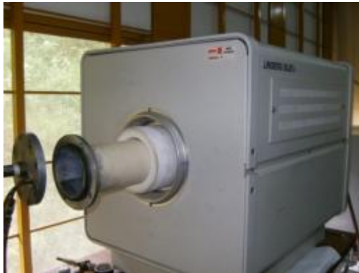
Figura 3-10. Horno tubular para tratamientos térmicos Marca Lindberg/Blue
