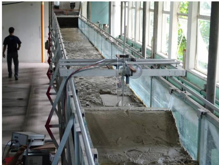
Ilustración 21. Canal de recirculación de agua y sedimentos finos (arena) en el laboratorio del IMF.
