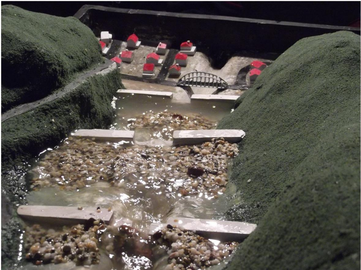
**Ilustración 61. Ensayo con sistema estructurado de presas (vista hacia aguas abajo).**
