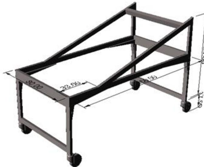
Ilustración 47. Diagrama del carro de transporte desplegado, medidas en cm.
