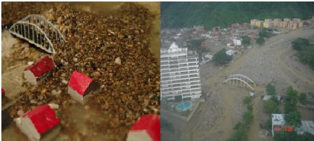
**Ilustración 54. Izq. Reproducción de alud torrencial en el modelo, Der. Imagen tomada en Camurí Grande, Edo. Vargas, 2005.**
