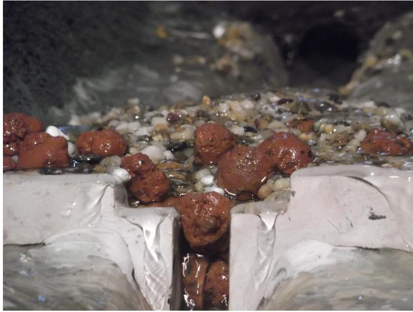
**Ilustración 59. Ensayo con presa ranurada.**
