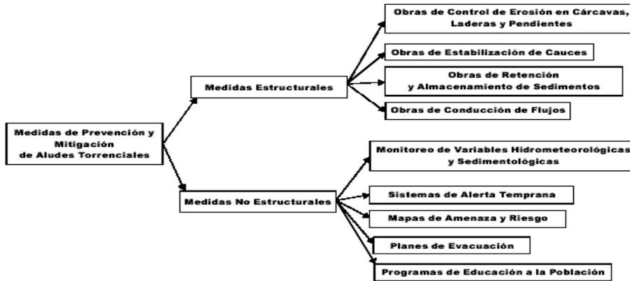
Ilustración 6. Esquema de medidas de prevención de aludes torrenciales
