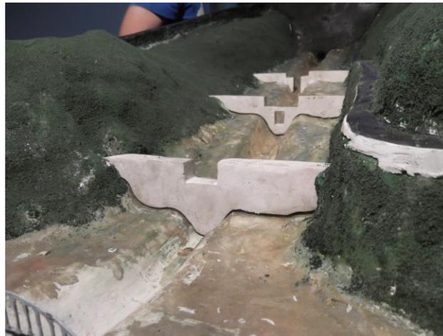
**Ilustración 46. Presas posicionadas en la garganta de la cuenca.**
