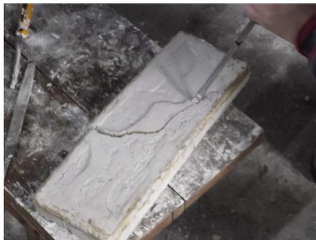
**Ilustración 45. Proceso de desmolde de las presas.**
