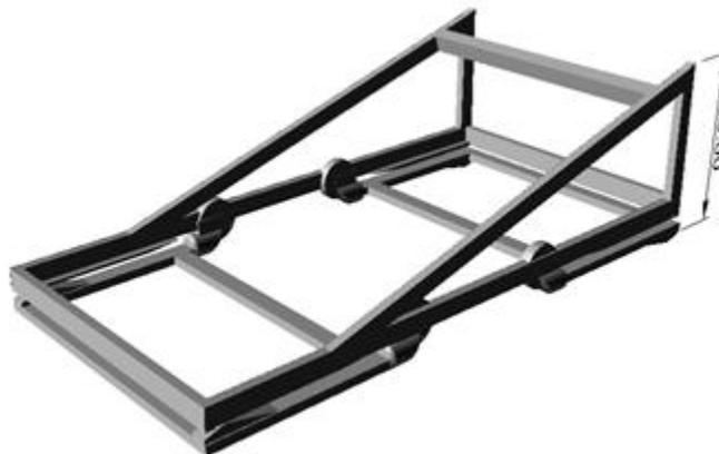
Ilustración 48. Diagrama del carro de transporte plegado, medidas en cm.
