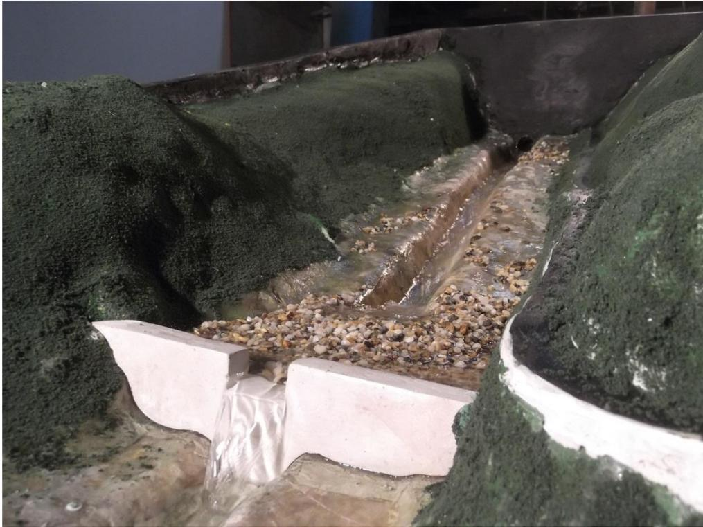
**Ilustración 56. Ensayo con sedimentos y presa cerrada.**
