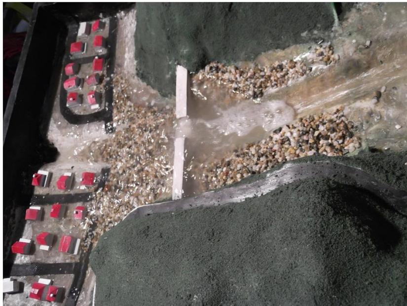
**Ilustración 57. Ensayo con sedimentos y presa cerrada con caudal aumentado.**
