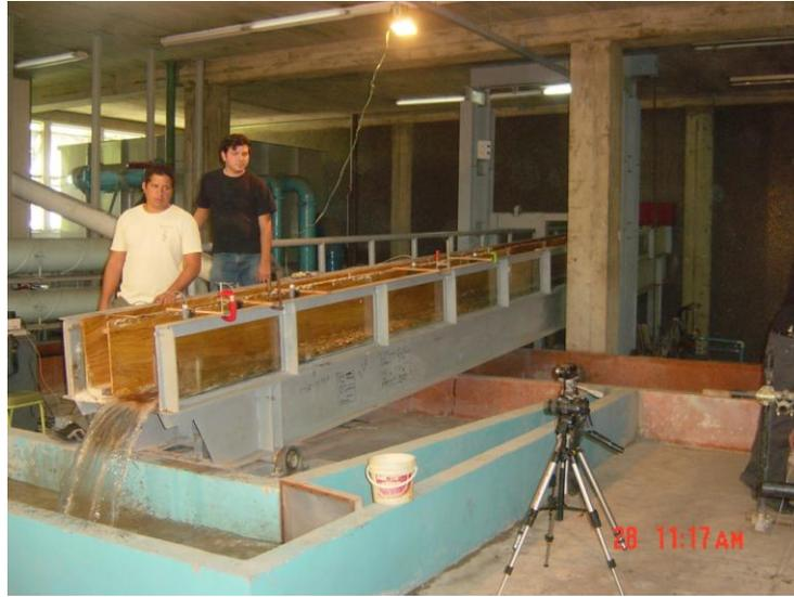
**Ilustración 22. Canal de flujo torrencial para ensayos con sedimentos gruesos en el laboratorio del IMF.**
