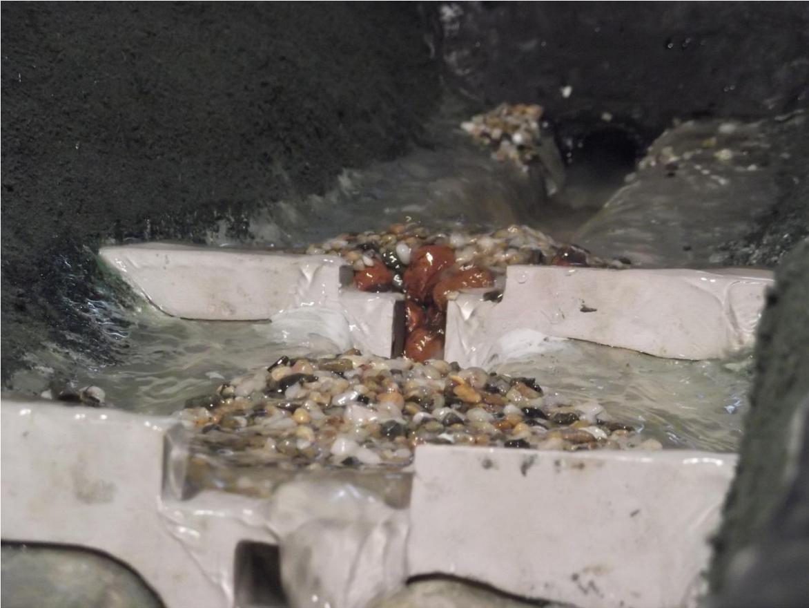
**Ilustración 62. Ensayo con sistema estructurado de presas. Vista hacia aguas arriba.**
