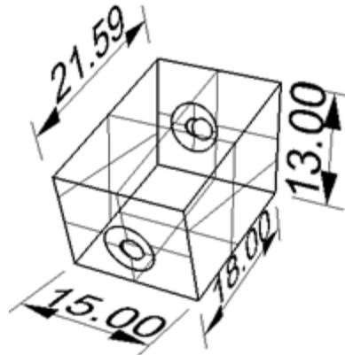
Ilustración 34. Diagrama del tanque de descarga, medidas en cm.
