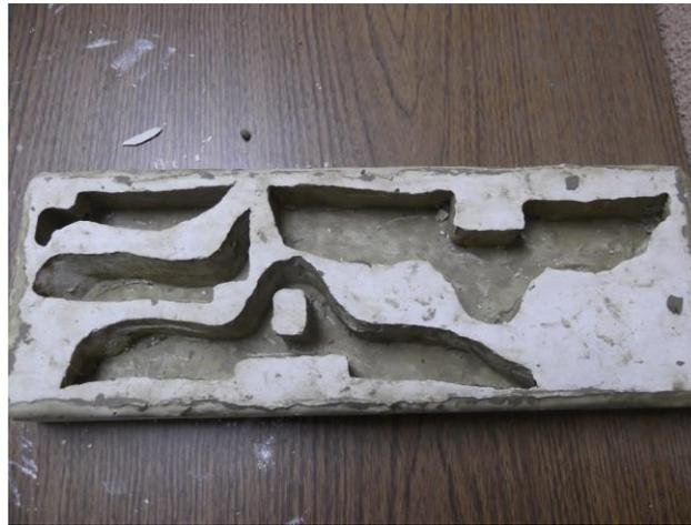
**Ilustración 44. Molde de yeso para fabricación de las presas.**
