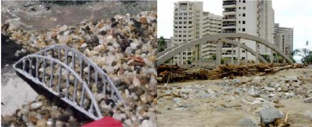
**Ilustración 55. Izq. Obstrucción en el puente tomada durante un ensayo en el modelo, Der. Imagen tomada en Camurí Grande, Edo. Vargas, 2005.**
