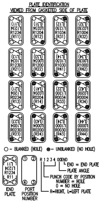
Figura C.4. Identificación de Placas del Intercambiador de Jarabe Simple
