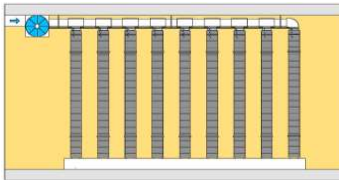
Figura 15: Paso 2 del armado del Sistema. Instalación de sustrato, geotextil y sistema de riego.
