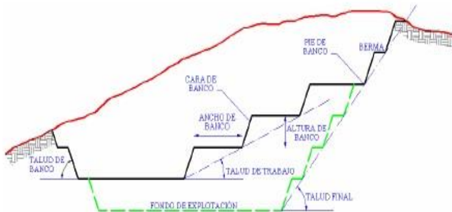
Figura 13: Terminología utilizada en minería a cielo abierto Fuente: (Bustillo & Lopez, 1997)
