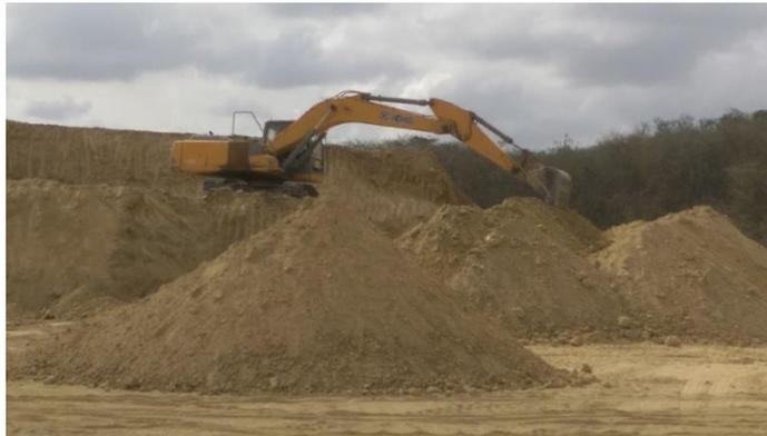
Figura N°11: Arranque mecánico y clasificación de material con Excavador XCMG XE230
