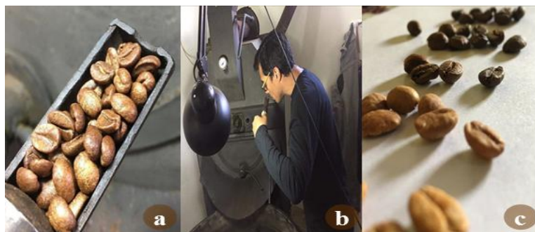
Figura 14. Proceso de tostado en la organización café Trinidad. Calador de muestra (a), análisis sensorial por parte del tostador (b) y diferentes grados de tostado (c).
