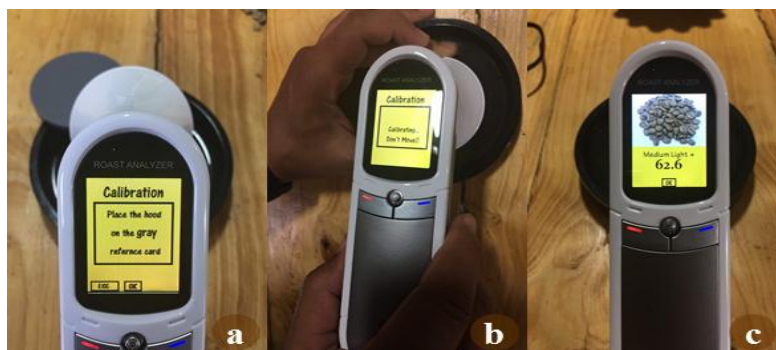
Figura 20. Proceso de medición de los niveles de tostado: calibración del equipo (a) y (b), medición del número “Agtron”(c).
