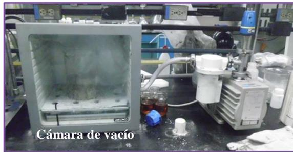
Figura 3.11. Equipo de saturación
