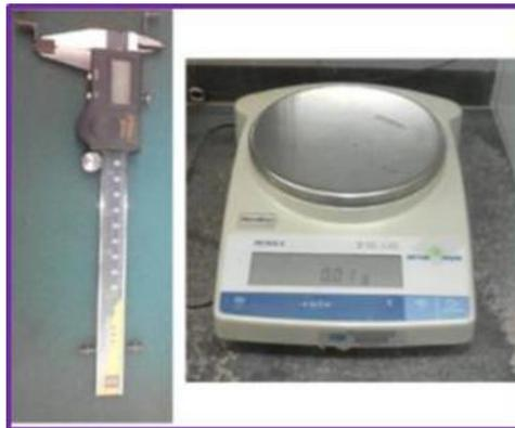
Figura 3.5. Vernier digital y Balanza digital.
