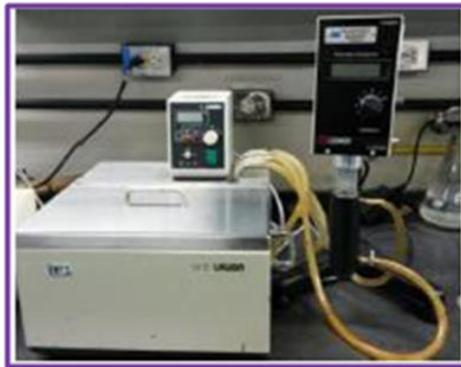
Figura 3.9. Viscosímetro CANNON V-2000.
