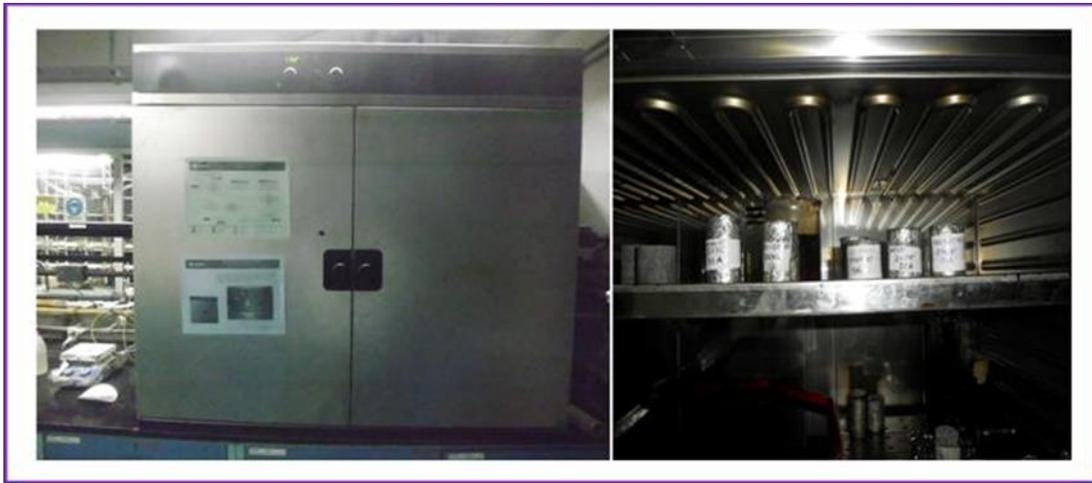
Figura 3.2. Horno de secado de muestras. Muestras secándose.
