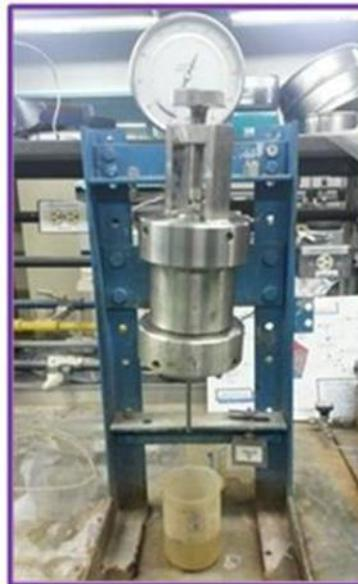
Figura 3.3. Celda de confinamiento.
