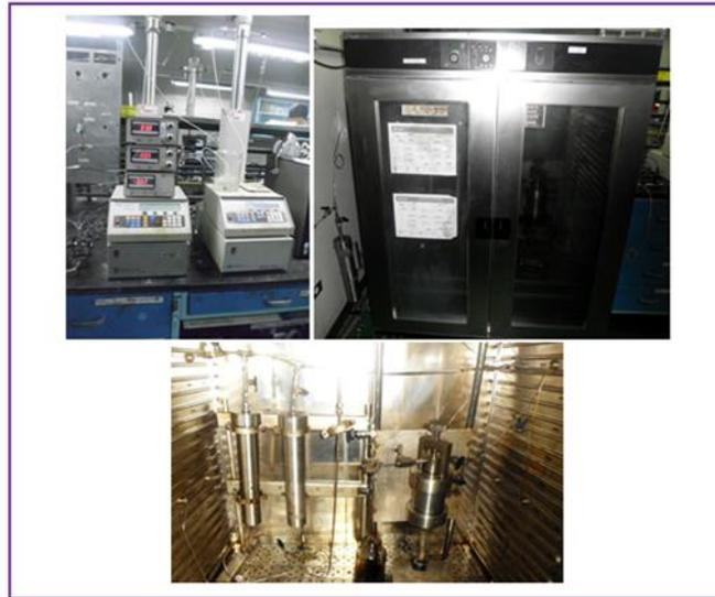
Figura 3.13. Equipo de desplazamiento forzado de fluidos (Bombas de inyección, horno, cilindros y celda triaxial).
