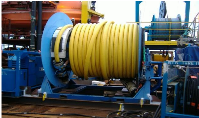
Figura 2.4 Carrete de riser flexible. Tomado de Instituto Mexicano del Petróleo, 2008.
