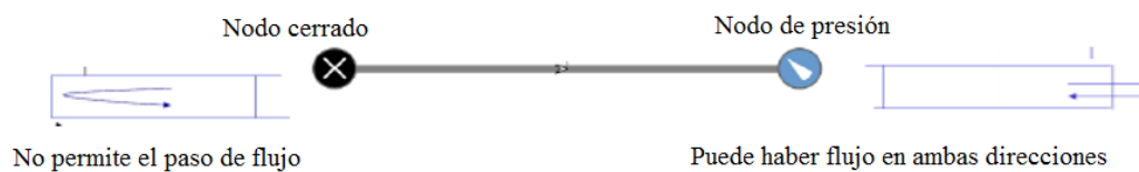
Figura 2.50 Diferencias entre nodo cerrado y nodo de presión. Tomado de Schlumberger, 2014.
