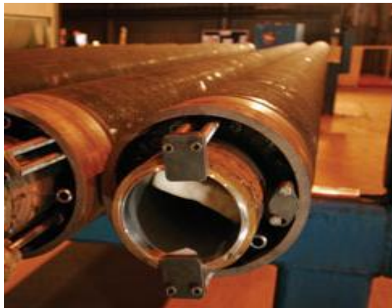
Figura 2.35 Configuración pipe-in-pipe . Tomado de PETROBRAS, 2008.
