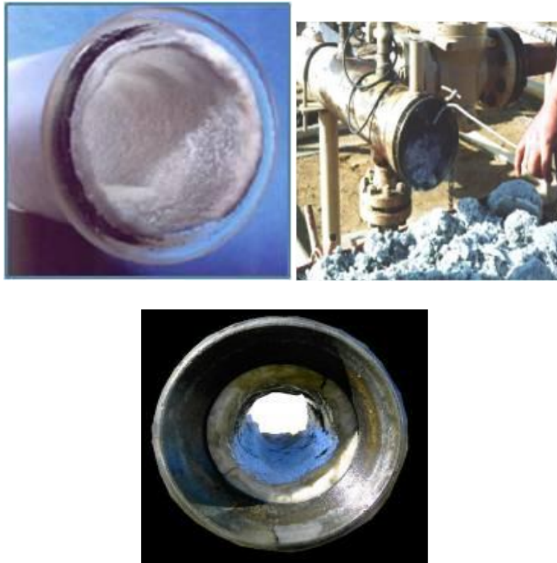
Figura 2.31 Formación de hidratos en tuberías y equipo de tratamiento en superficie. Tomado de PETROBRAS, 2008.
