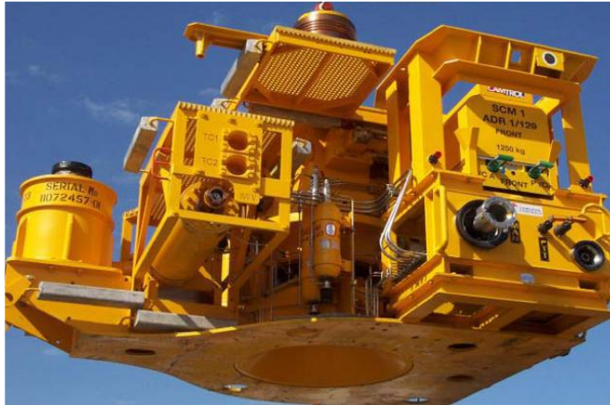
Figura 2.10 Árbol submarino horizontal. Tomado Pemex-ABB, 2009.
