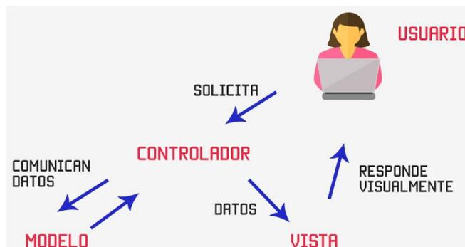
Figura 9 - Modelo Vista Controlador (MVC)
