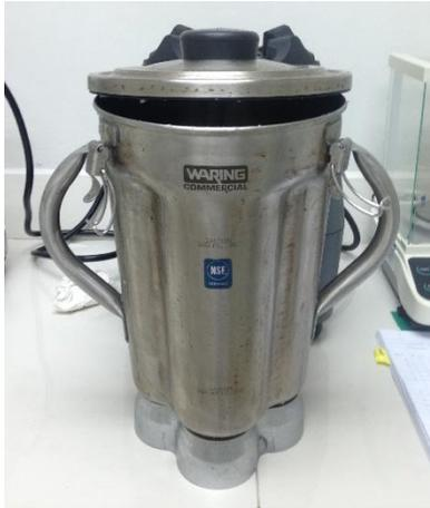
**Figura 6.** Licuadora Waring Commercial One-Gallon 3.75 HP Food Blender utilizada para homogenizar las muestras de pulpa de coco.
