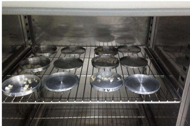
**Figura 11.** Determinación de humedad en estufa de aire forzado.
