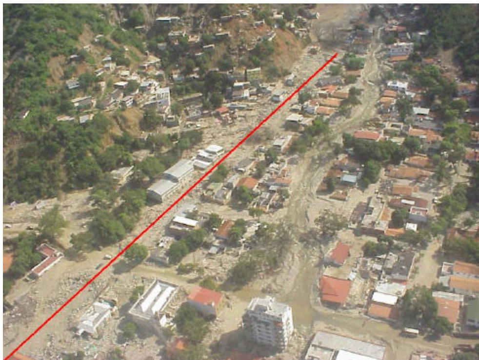
Figura 20 Vista de la población de Macuto después de los aludes torrenciales de diciembre 1999. La línea roja indica el sitio del cauce original.
