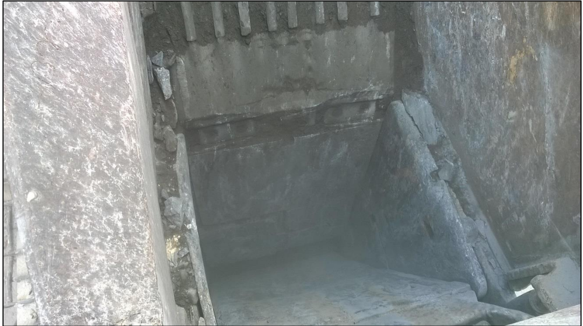
Figura 28 - Fractura de plancha fija de la trituradora primaria de mandíbula, Fuente: Elaboración propia
