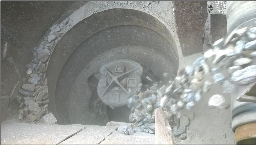
Figura 38 - Desgaste de los forros de la trituradora de cono 1, Fuente: Elaboración propia
