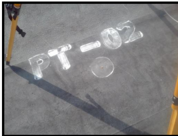
Figura 25. Punto de control PT-02, ubicado en techo de oficina.
