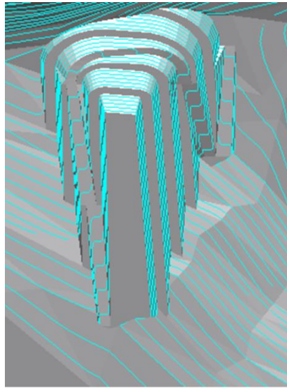
Figura 10. Modelo 3D del pit final del Frente de lascas.
