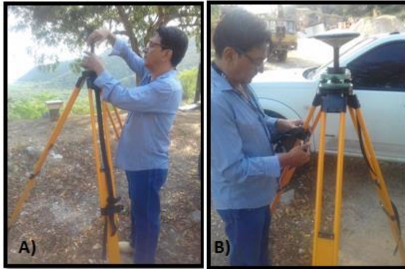
Figura 24. A) Instalación la antena receptora en el trípode. B) Instalación del GPS en el trípode.
