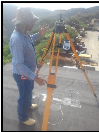
Figura 26. Chequeo de posición de la antena del GPS.
