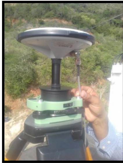
Figura 29. Conexión del cable de comunicación con la antena.
