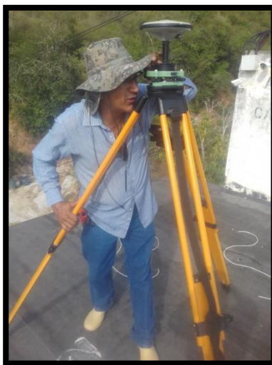
Figura 27. Nivelación del trípode mientras se chequea el nivel circular.
