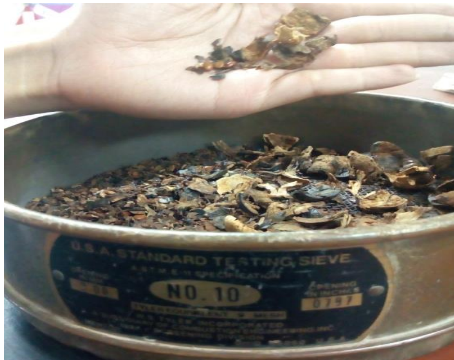
Figura 45. Sólidos retenidos en el tamiz de 10 Mesh
