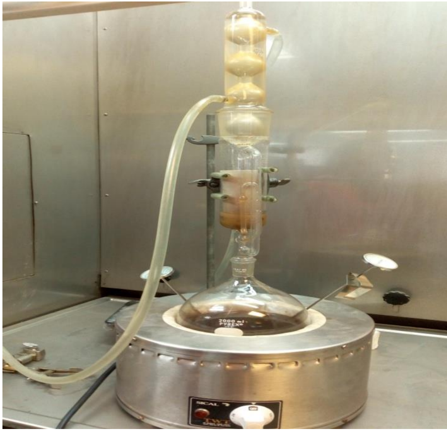
Figura 28. Sistema de extracción Soxhlet
