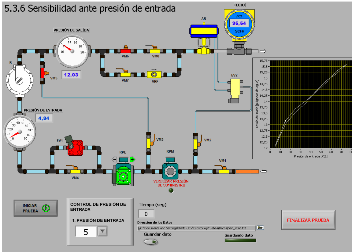
Figura 5. 4. Panel frontal de la prueba sensibilidad ante la presión de entrada. Elaboración propia.
