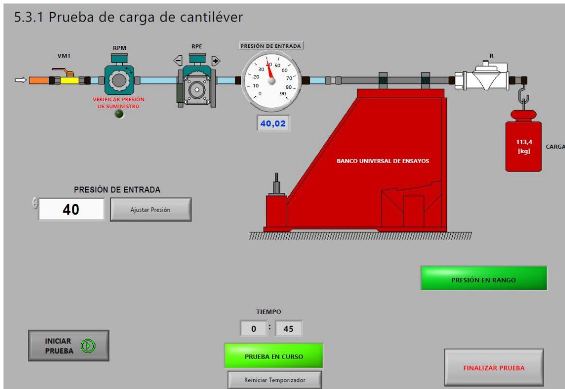
Figura 4. 28. Panel frontal para rutina de prueba de carga en cantiléver.
