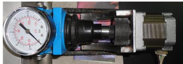
Regulador de presión automático de 0 a 90 psig con manómetro
