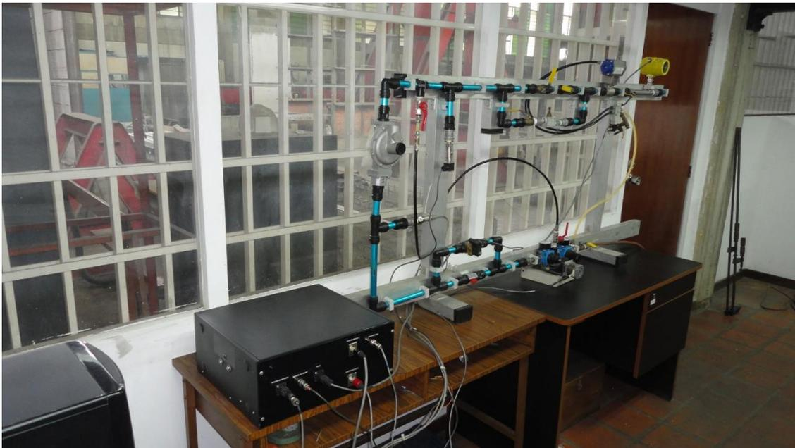
**Figura anexa 2. Vista de la caja de instrumentación y circuito neumático.**
