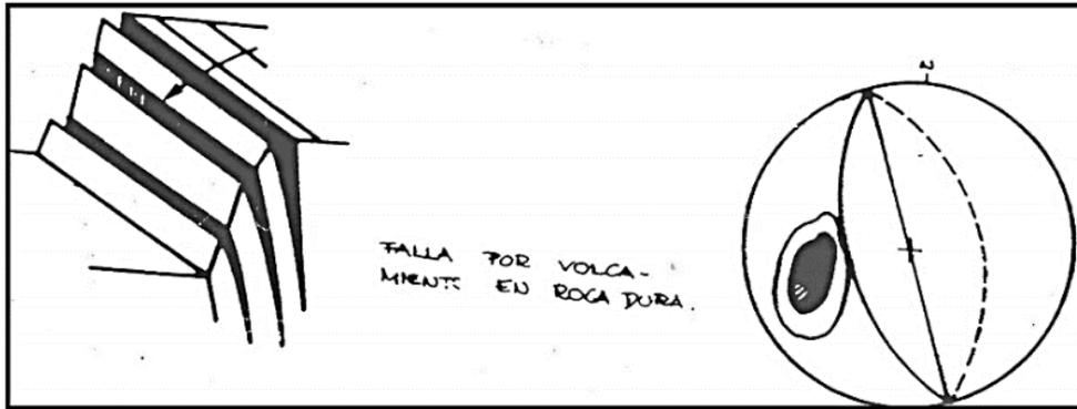
Figura 10. Falla por volcamiento y configuración estereográfica
