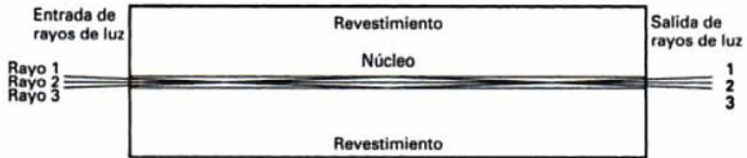
Figura 4. Propagación de luz por fibra unimodal de índice escalonado [2].
