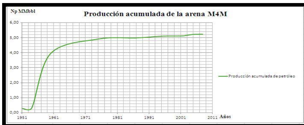
Figura 38. Producción acumulada de petróleo arena M4M (Oilfield Manager, 2008)
