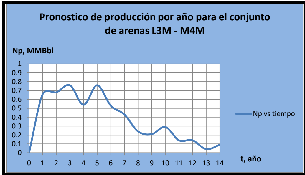
Figura 88. Pronóstico de producción anual para el conjunto de arenas L3M – M4M, obtenidas por el método de Buckley – Leverett y Welge
