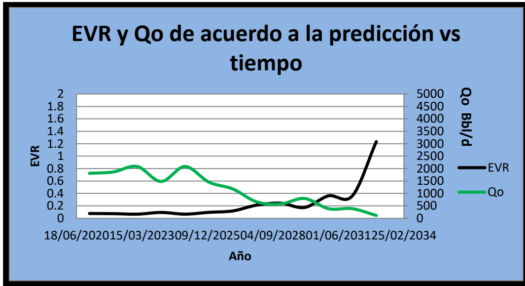
Figura 89. Comportamiento de la eficiencia volumétrica de reemplazo a futuro
