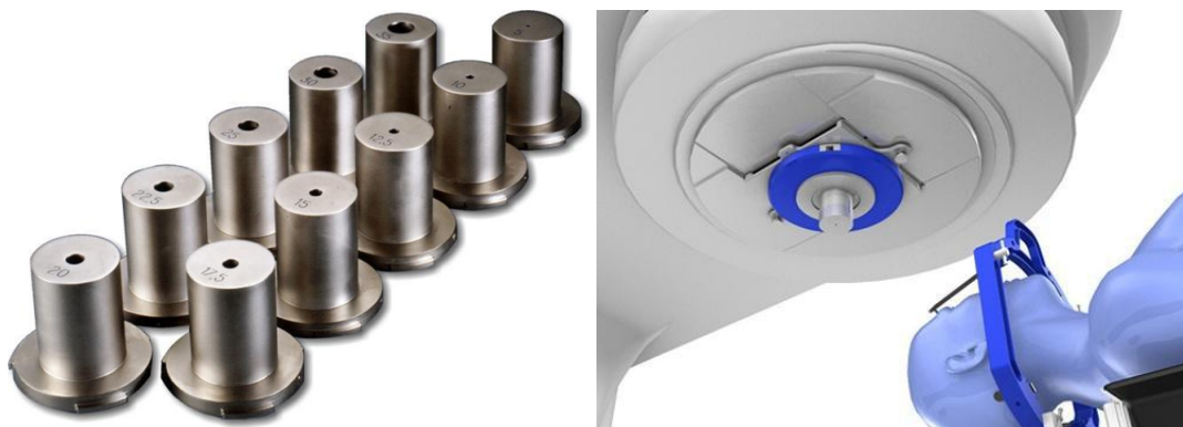
Figura 1: conos del sistema de radiocirugía BrainLAB® (izquierda). Cono acoplado al cabezal de acelerador lineal (derecha).
