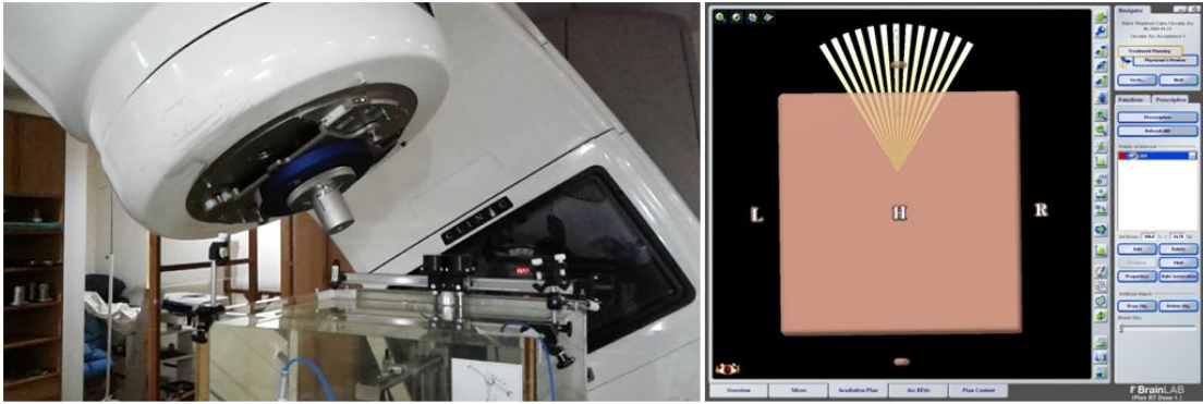
Figura 23: derecha: montaje experimental para la medición de la dosis. Izquierda: plan de tratamiento diseñado en el SPT.
